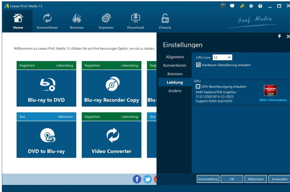
Stellen Sie auf der Registerkarte "Leistung" den CPU-Kern ein, aktivieren Sie die Hardware-Dekodierung und wählen Sie die GPU-Beschleunigung.
